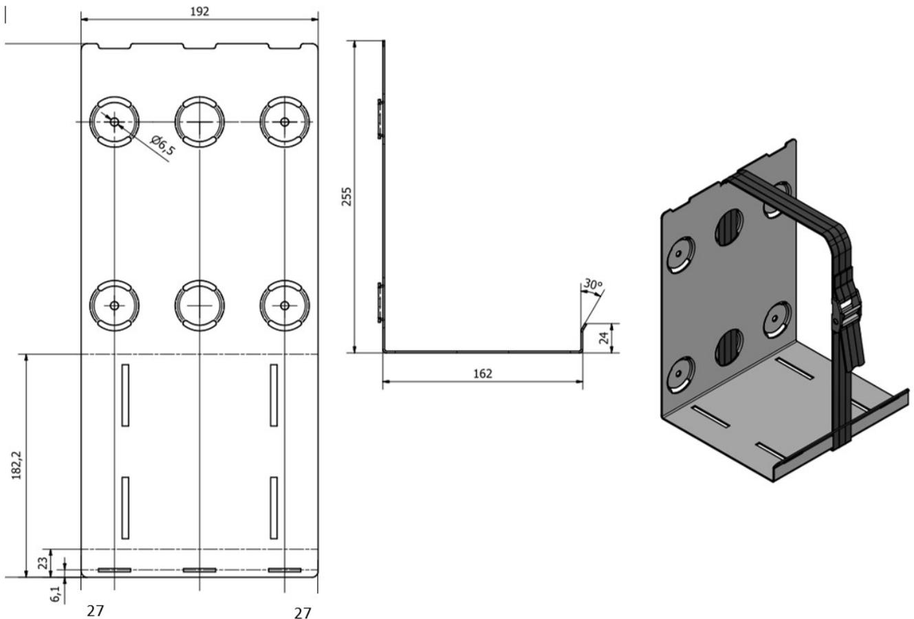
Die Halterung wird ohne Schrauben oder anderem Zubehör geliefert, da die Montage an die einzelnen Montageflächen und -bedingungen angepasst werden sollte. Wichtig zu bedenken ist, dass die Montage in einem Fahrzeug unter besonderer Berücksichtigung der Konstruktion des Fahrzeugs erfolgt, am besten mit Hilfe eines Fachmanns.
